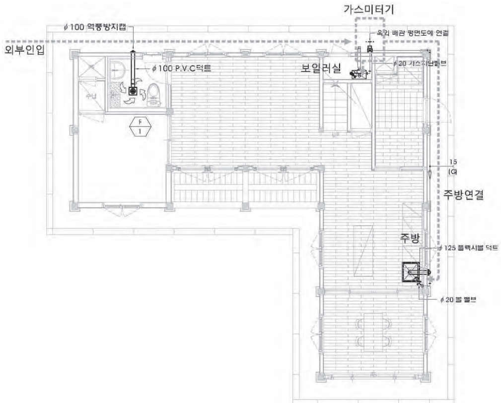
그림 12-48. 가스배관 및 환기덕트 평면도
