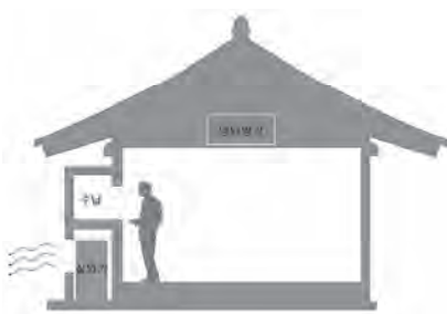
그림 12-39. 실외기 설치 1 (반침 활용)
