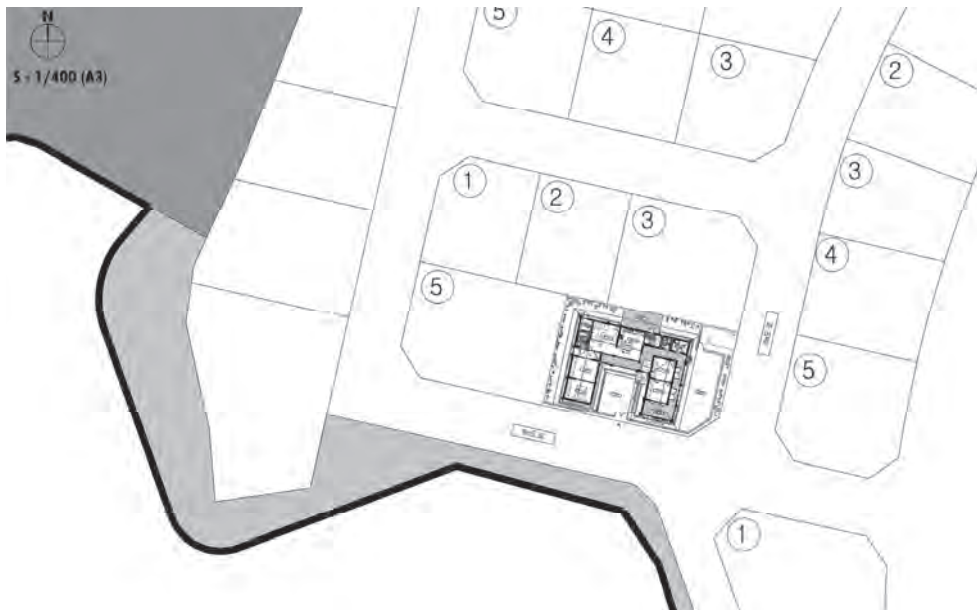
그림 2-5. 교외 한옥 배치의 사례(출처: ATA + CS PLAN) 주변에 다층의 건물이 세워질 가능성이 높으므로 택지가 없는 남쪽으로 열린 ㄷ자형 배치를 했다.
