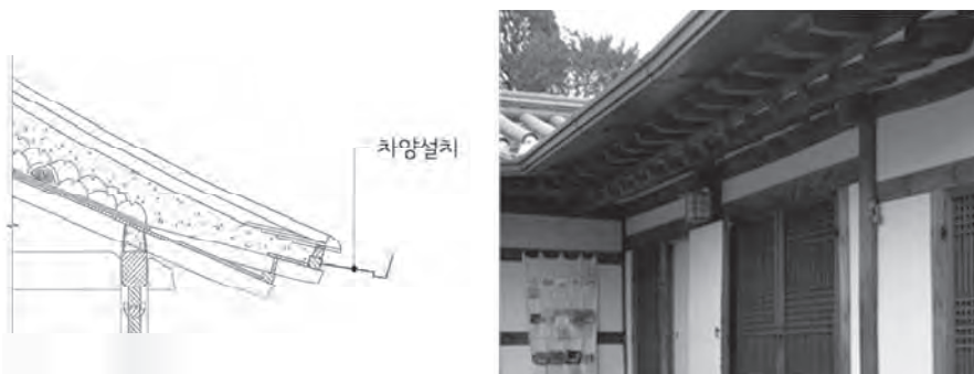
그림 7-16. 서울 북촌의 일반적인 차양 수법-단면도(좌), 차양 사진(우)
