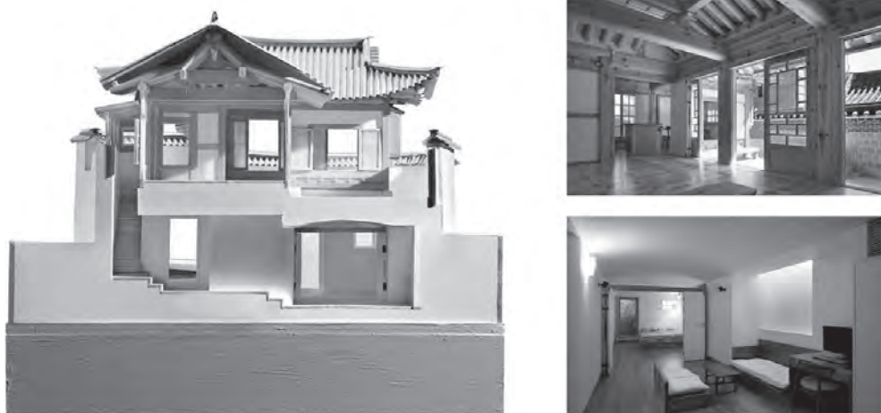
그림 8-22. 단면모형과 실내 사진 지상에는 전통 대청을, 지하에 모던한 한실을 계획했다.
