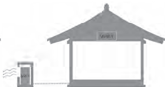
그림 12-40. 실외기 설치 2 (외부 별도 설치)
